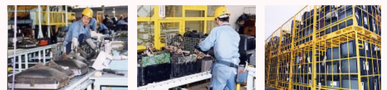
テレビの総重量の62%を占めるブラウン管。9つの行程を経て10種の回収物に分別されます。 家電4品目の中で一番手間がかかるテレビ。写真は手解体で裏カバーを外しているところ。 廃家電は各地から回収され、品目別にコンテナに詰められ保管されています。
