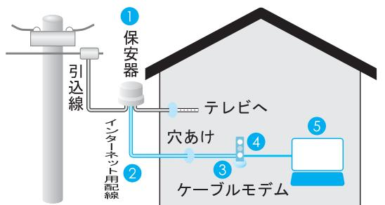
1 電柱から建物にケーブルを引き込み、軒先に保安器を取り付けます。※
